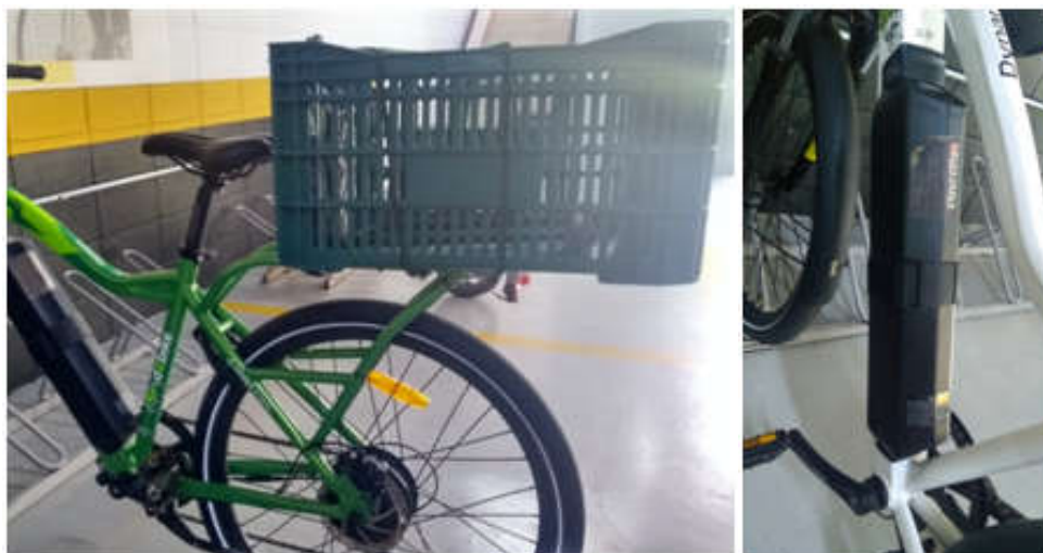
Figura 13. Detalhe do cargueiro soldado no quadro e da bateria. Fonte: LABMOB (2019).
